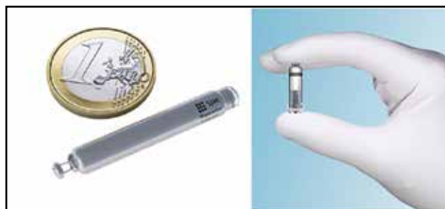
Εικόνα 1. Βηματοδοτικά συστήματα άνευ καλωδίων: Nanostim™ Leadless Pacemaker System (St. Jude Medical, St Paul, MN, ΗΠΑ), και Micra™ Transcatheter Pacing System (TPS) (Medtronic, Minneapolis, MN, ΗΠΑ).
